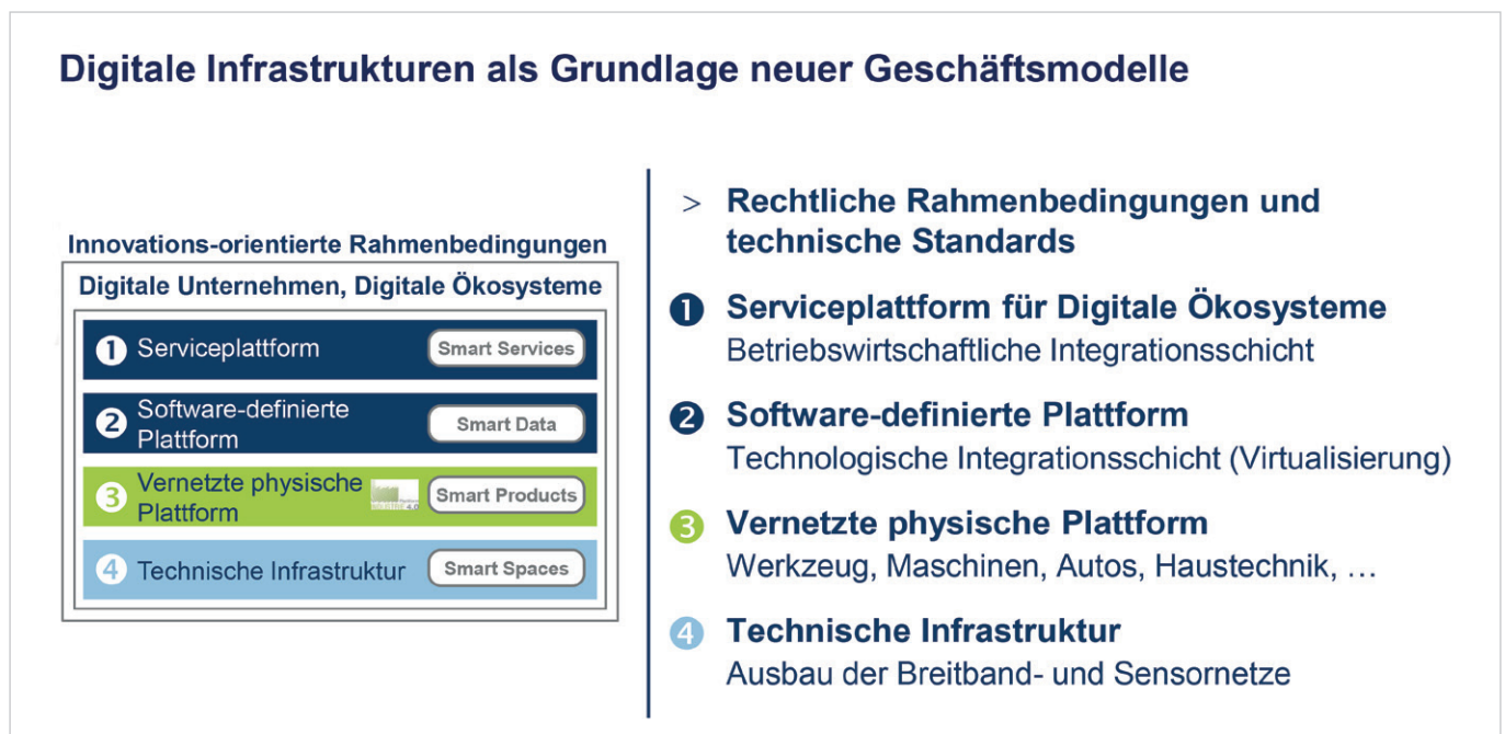
Bild 8.3: Konzept und Architektur softwaredefinierter Plattformen in der Smart-Service-Welt (Quelle: Acatech)
