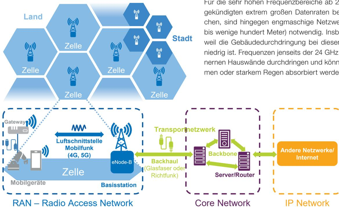
Abbildung 7: Vereinfachte, schematische Darstellung des Aufbaus eines Mobilfunknetzwerks.
